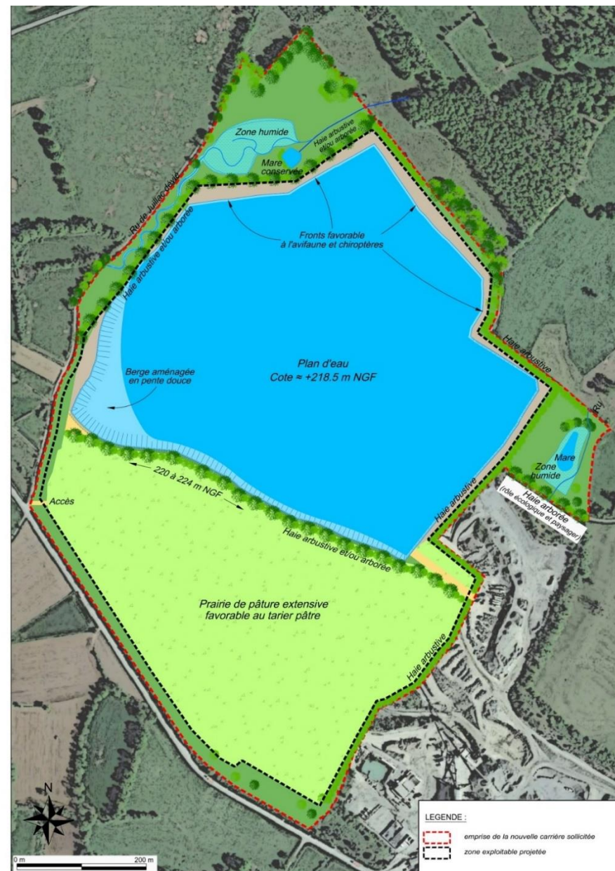
Esquisse du plan de remise en état à long terme après remontée des eaux
